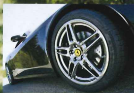
↑足回りはKWとノヴィテックの共同開発による減衰力・車高調整式。ホイールはNF2。サイズはフロント9J×19、リア12J×20をセット
