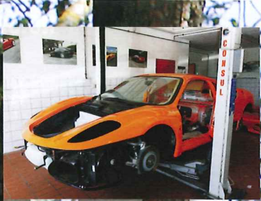
↑作業を待つF430。細部にまで渡ってストリップされ、ノビテックのパーツへと変更されていく。もちろん一台一台手作業だ
