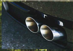
↑リアスカートのアールに沿うようなテール。サイズは90φのデュアル、アイドリングでは太く力強く、高回転では美しい音色を奏でる
